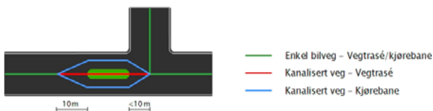
Figur 28: Avstanden fra hindringen til skillet mellom vegtrasé og kjørebane skal normalt sett være 10 meter.
