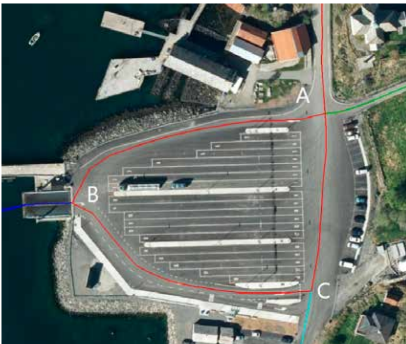
Figur 38: Vegnett på ferjekai som adskilte løp. En del ferjekaier har lagt opp kjøremønsteret slik at det er ett sted for å kjøre inn til kaianlegget og utkjøring er på en annen plass. Da kan løsningen være å legge inn vegnettet som enkel bilveg med envegsregulering. Strekningen inn og ut av selve ferjen vil være naturlig å legge inn som enkel bilveg med toveistrafikk. I eksemplet over kan vi registrere vegnettet over ferjekaien som adskilte løp hvor strekningen A-B er medløpet og B-C-A er motløpet.
