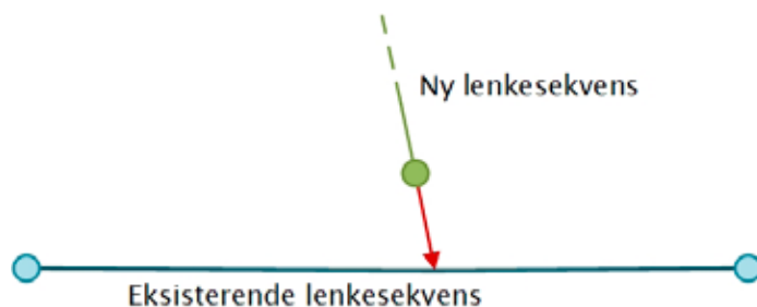
Figur 7: En ny veg som kobles til en eksisterende veg, splitter ikke den eksisterende lenkesekvensen. Lenken som lenkesekvensen består av, blir splittet i noden.
