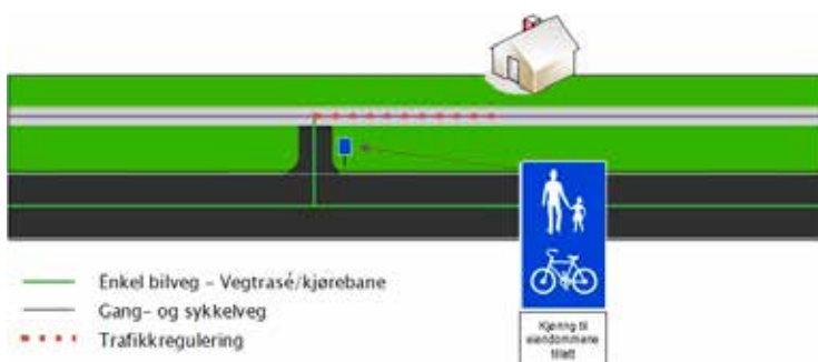
Figur 36: Gs-veg går over veg til eiendom, men denne vegen er skiltet som gs-veg. I slike tilfeller skal det stedfestes trafikkregulering «Motortrafikk kun tillatt for kjøring til eiendommer» på den aktuelle strekningen.
