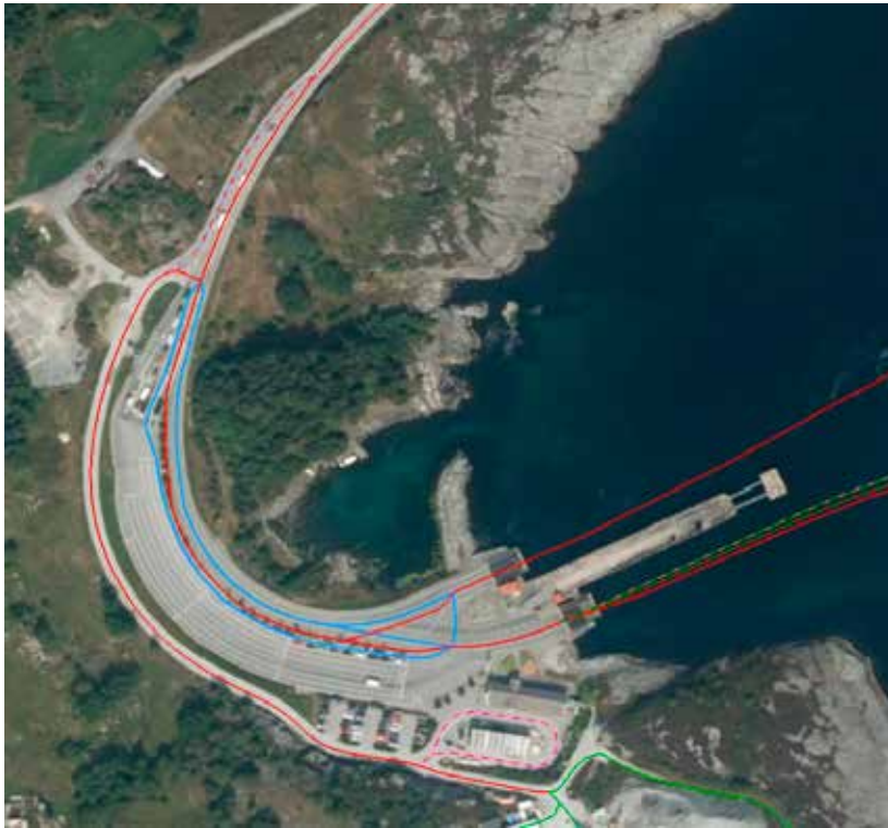
Figur 37: Vegnett på ferjekai som kanalisert veg. Der det er fysisk trafikkdelere som skiller toveistrafikken inn og ut av ferjen, vil det være naturlig å legge inn nivådelt vegnett. Geometrien for vegtrasé går i trafikkdelere, mens geometri for kjørebanelene legges i kjørefelt nærmest vegtraseen eller der hovedvekten av trafikken ut og inn av ferjekaia ledes. I dette eksemplet er det to ferjestrekninger som benytter samme oppstillingsplass. Vegen mot servicebygget og de private vegene i sør, er registrert som en arm.
