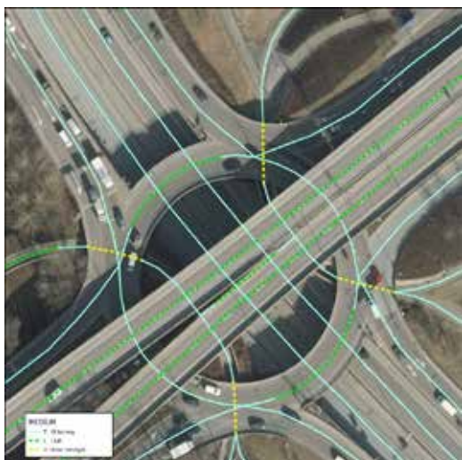
Figur 22: Eksempel på bruk av medium i Sinsenkrysset for ring 3 / rv. 4 i Oslo. Lenkene som ligger på samme nivå som terrenget (merket som T i figuren) lagres uten medium i NVDB.
