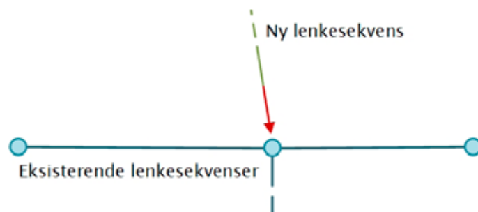
Figur 8: Tilkobling av ny veg til eksisterende T-kryss.
